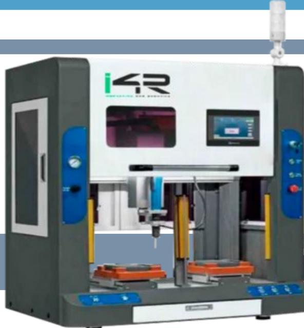
El robot de atornillado de tipo pick-up (basado en computadora) es un sistema robótico avanzado diseñado para automatizar tareas de atornillado. Utiliza algoritmos informáticos para recoger y atornillar con precisión los tornillos en las posiciones designadas. Este tipo de robot es ideal para ensamblajes complejos que requieren alta precisión y repetibilidad, mejorando la productividad y la calidad en entornos de fabricación.
