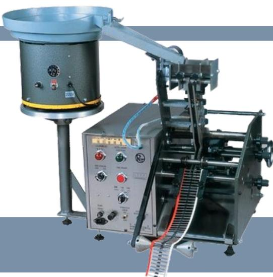
**Máquina de corte y preformado de componentes axiales en tape & bulk. Esta máquina permite el corte y doblez de resistencias, diodos y demás componentes axiales para un montaje en horizontal sobre la PCB. Además con un herramiental de preforme se pueden realizar candados en la terminal del componente, garantizando su posición fija en el PCB.**
