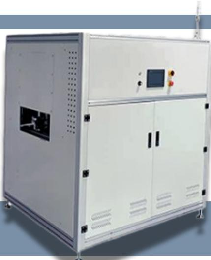
El Cooling Buffer enfriá y almacena temporalmente las PCBs al salir del horno de reflow, asegurando que alcancen la temperatura adecuada para inspección o manipulación. Su diseño de múltiples niveles mantiene el flujo estable cuando la siguiente estación está ocupada, evitando deformaciones térmicas y cuellos de botella.
