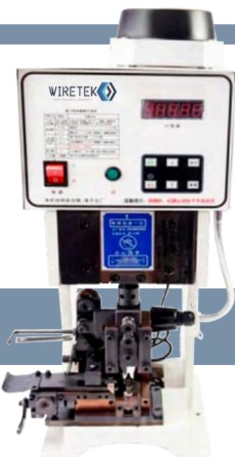
Máquina semiautomática de prensado con fuerza de 1.5 toneladas, silenciosa y compacta, adecuada para crimpar terminales con moldes verticales.
