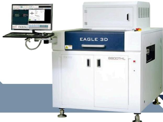
Sistema de inspección óptica 3D diseñado para detectar defectos en uniones de soldaduras Through-Hole. Utiliza tecnología de proyección de luz sin sombras (shadowless 3D) que asegura mediciones precisas de altura, forma y volumen, incluso en zonas con alta densidad de pines. Ofrece inspección inferior y superior, análisis simultáneo en 2D/3D y compatibilidad con placas de gran formato.
