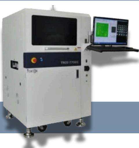
Sistema in-line de inspección de pasta que combina Dual Projection con algoritmos 2D + 3D PMP (Phase Measuring Profilometry) para eliminar sombras y medir con precisión volumen, altura, área y posición XY. Ofrece cámaras de 4-10 MP (10/15/18  $\mu$ m).
