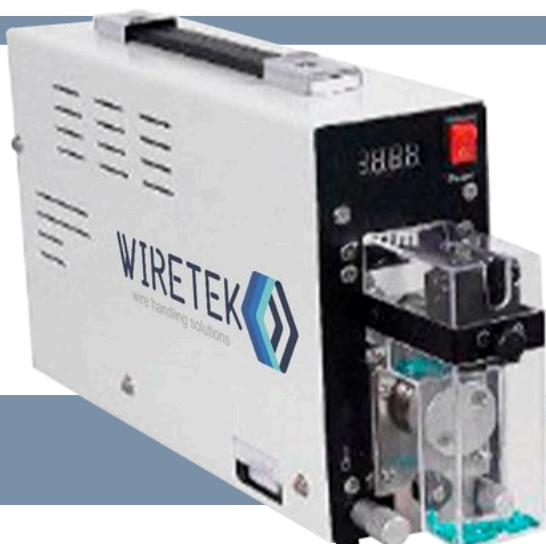
Equipo compacto capaz de desforrar cables, para posteriormente colocar y prensar férulas tubulares en la sección del cable desforrado. La eficiencia general aumenta hasta un 400% respecto a operaciones manuales con pinzas crimpadoras.
