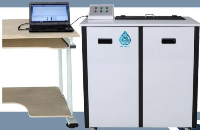
Equipo de alta precisión diseñado para medir el nivel de contaminación iónica en PCBs. Utiliza el método ROSE para extraer y cuantificar iones, presentando los resultados como equivalentes de NaCl. Genera informes que faciliten la trazabilidad de datos y ayuden en tus auditorías.
