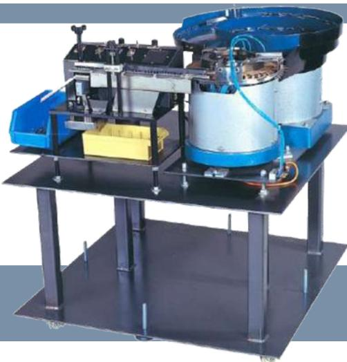
**Una versión para componentes de mayor tamaño. Esta máquina además de un bowl feeder, cuenta con un sistema de "carry-wheels" que permite procesar componentes de gran tamaño, lo cual la convierte en una máquina versatil capaz de procesar hasta 1,500 componentes por hora.**
