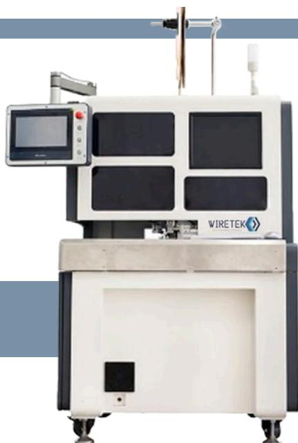
Máquina automática con capacidad para cortar y desforrar cable multihilo para posteriormente colocarle un conector y crimparlo.
