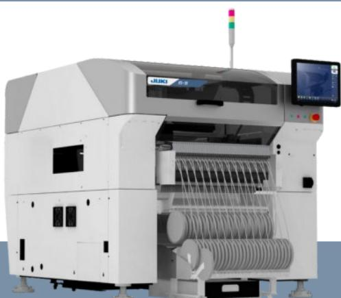
Montaje aún más rápido desde chips muy pequeños (sistema métrico 0201) hasta componentes grandes de 50 x 150 mm o 74 mm de longitud de arista para componentes cuadrados. El bastidor base del RS-2R se ha rediseñado completamente para este fin.
