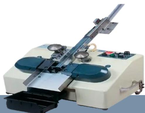
**Máquina de corte y preformado de componentes de potencia en presentación de vaina. Esta máquina procesa automáticamente los componentes mediante sus 4 dados de preformado. Su cambio rápido de herramientas permite procesar diferentes encapsulados, además, cuenta con un stick feeder, el cual permite apilar varias vainas con componentes, mejorando los tiempos de carga del material.**
