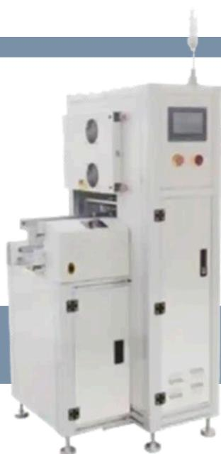
Conveyor diseñado para separar y almacenar temporalmente PCBs NG/OK después de pruebas como SPI/AOI, manteniendo el flujo sin detener la línea: las OK pasan directo al siguiente proceso y las NG se elevan o desvían para inspección/retrabajo. Soporta modos FIFO, LIFO y By-pass, con capacidad en rack/magazine configurable.
