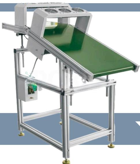
**Asegura la transferencia suave, estable y controlada de PCBs hacia las siguientes etapas de enfriamiento, inspección o prueba funcional. Su sistema de transporte por cadena o malla de acero inoxidable, con velocidad ajustable y control térmico opcional, evita choques o deformaciones en las PCBs recién soldadas. Puede incorporar ventiladores de enfriamiento o sensores de salida para automatizar la detección de producto terminado.**
