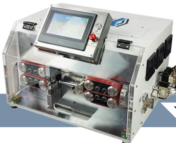
La WS-30A está diseñada para el corte y pelado automático de cables unipolares de diversos tamaños. También permite cortar y pelar la cubierta de los cables. Esta máquina se utiliza ampliamente en el procesamiento de motores de nueva energía, estaciones de carga, sistemas de control electrónico y cables de alimentación de alta potencia utilizados en Columbia Británica
