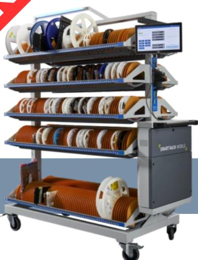
Este rack inteligente es capaz de localizar los rollos de SMT en segundos. Gracias a su guía visual por luces LED y validación por escaneo, el operador accede a sus materiales con máxima rapidez, sin errores. El único rack de su tipo con la capacidad de modificar el tamaño de los compartimentos de forma fácil y automática, además de conectarse con otro rack para intercambios fáciles de material.
