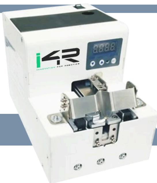
El destornillador manual automático con plato giratorio se utiliza para tornillos de cabeza fina, tornillos con una relación de aspecto de 1:1 y otros tornillos difíciles de colocar.
